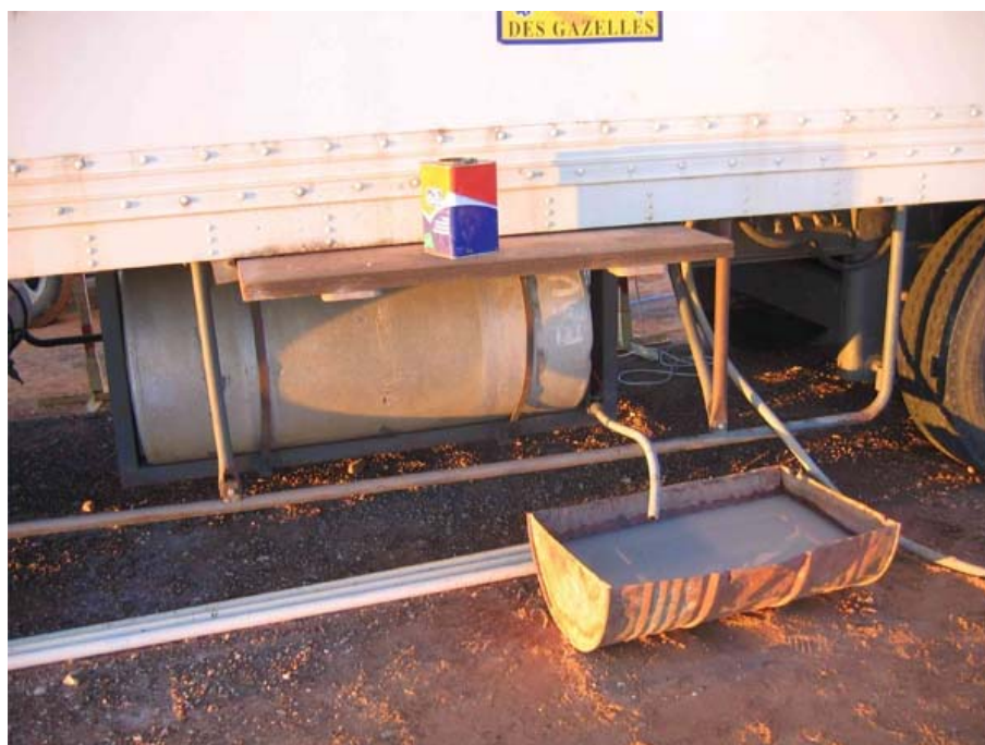
Mise en place de rétentions
